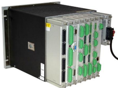
Mini Rack Back View – I/O Modules
